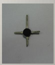
Технические преимущества прибора по сравнению с известными полупроводниковыми СВЧ смесительными и квадратичными диодами, в том числе и диодами Шоттки заключаются в обеспечение квадратичной передаточной характеристики в широком динамическом и частотном диапазонах, отсутствии реактивной составляющей входного сопротивления, обусловленной барьерной емкостью
