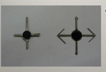
❖ Образцы приборов в корпусе снабжены двумя входными и двумя выходными выводами, входное и выходное сопротивление соответственно 24 и 30 Ом, максимальное значение входного тока 100 мА, рабочая часта до 10 ГГц, температурный диапазон −70°... +150° С
